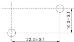
2-φ3.1安装孔 或M3螺丝孔
